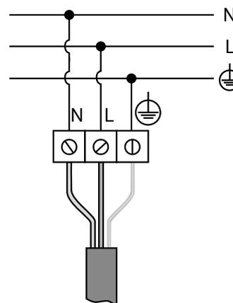
Abb. 61 Elektrischer Anschluss
