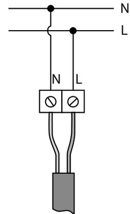
Abb. 64 Elektrischer Anschluss
