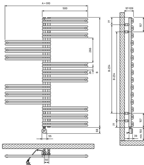
Abb. 24 Abmessungen und Montage Maße
