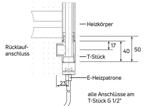
Abb. 112 Montage der PTC-Heizpatrone mit T-Stück an Heizkörpern **ohne** Anschluss mit 50 mm Nabenabstand (Flores und Flores C)
