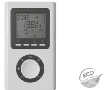
Abb. 26 Der FCIR-Infrarotraumthermostat ist im Lieferumfang inbegriffen. Er ermöglicht die Einstellung der Raumtemperatur im Bereich von 10 °C bis 30 °C mit einer Schrittweite von 0,5 °C. Das Gerät zeigt die aktuelle und eingestellte Temperatur sowie die aktuelle Uhrzeit an. Wandmontage oder Tischaufstellung sowie Wochenprogrammerstellung und Timerfunktion (15 Minuten bis 4 Stunden) sind möglich. Stromversorgung über 2x LR03 (AAA) Batterien
