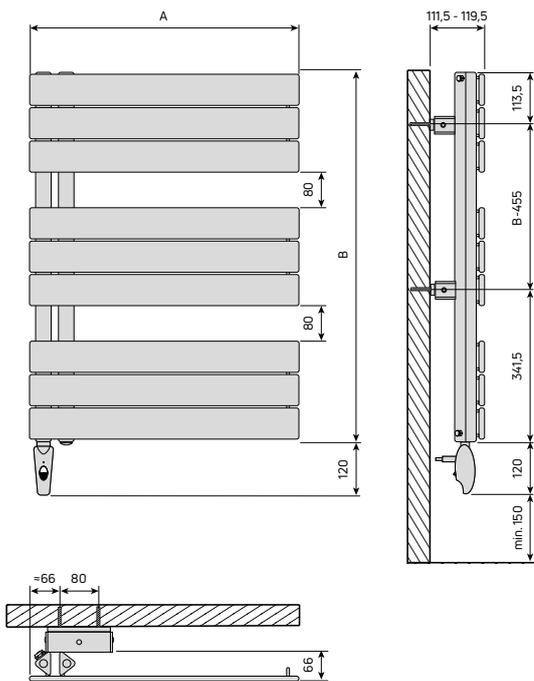
Abb. 96 Abmessungen und Montage Maße (Darstellung: Anschluss links)
