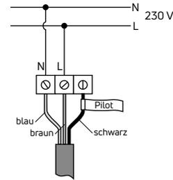
Abb. 110 Elektrischer Anschluss
