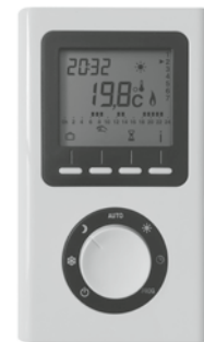
Abb. 38 Der FCIR-Infrarotraumthermostat ist im Lieferumfang inbegriffen. Er ermöglicht die Einstellung der Raumtemperatur im Bereich von 10 °C bis 30 °C mit einer Schrittweite von 0,5 °C. Das Gerät zeigt die aktuelle und eingestellte Temperatur sowie die aktuelle Uhrzeit an. Wandmontage oder Tischaufstellung sowie Wochenprogrammerstellung und Timerfunktion (15 Minuten bis 4 Stunden) sind möglich. Stromversorgung über 2x LR03 (AAA) Batterien
