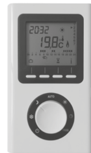
Abb. 46 Der FCIR-Infrarotraumthermostat ist im Lieferumfang inbegriffen. Er ermöglicht die Einstellung der Raumtemperatur im Bereich von 10 °C bis 30 °C mit einer Schrittweite von 0,5 °C. Das Gerät zeigt die aktuelle und eingestellte Temperatur sowie die aktuelle Uhrzeit an. Wandmontage oder Tischaufstellung sowie Wochenprogrammerstellung und Timerfunktion (15 Minuten bis 4 Stunden) sind möglich. Stromversorgung über 2x LR03 (AAA) Batterien
