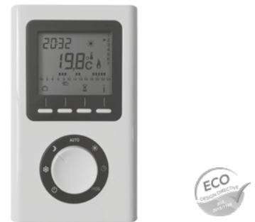
Abb. 38 Der FCIR-Infrarotraumthermostat ist im Lieferumfang inbegriffen. Er ermöglicht die Einstellung der Raumtemperatur im Bereich von 10 °C bis 30 °C mit einer Schrittweite von 0,5 °C. Das Gerät zeigt die aktuelle und eingestellte Temperatur sowie die aktuelle Uhrzeit an. Wandmontage oder Tischaufstellung sowie Wochenprogrammerstellung und Timerfunktion (15 Minuten bis 4 Stunden) sind möglich. Stromversorgung über 2x LR03 (AAA) Batterien
