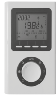
Abb. 26 Der FCIR-Infrarotraumthermostat ist im Lieferumfang inbegriffen. Er ermöglicht die Einstellung der Raumtemperatur im Bereich von 10 °C bis 30 °C mit einer Schrittweite von 0,5 °C. Das Gerät zeigt die aktuelle und eingestellte Temperatur sowie die aktuelle Uhrzeit an. Wandmontage oder Tischaufstellung sowie Wochenprogrammerstellung und Timerfunktion (15 Minuten bis 4 Stunden) sind möglich. Stromversorgung über 2x LR03 (AAA) Batterien
