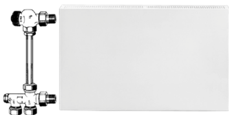
Abb. 58 Einrohranschluss mit hochgezogenem Vorlauf (bauseits)
