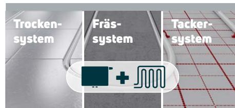
Der Betrieb von Fußbodenheizungssystemen bei einer Heizlast von 80 W/m<sup>2</sup> ist nur **als Ergänzung** zum gewählten Wärmeübergabesystem sinnvoll. Die Vorlauftemperatur ist über eine **Regelstation** anzupassen.
